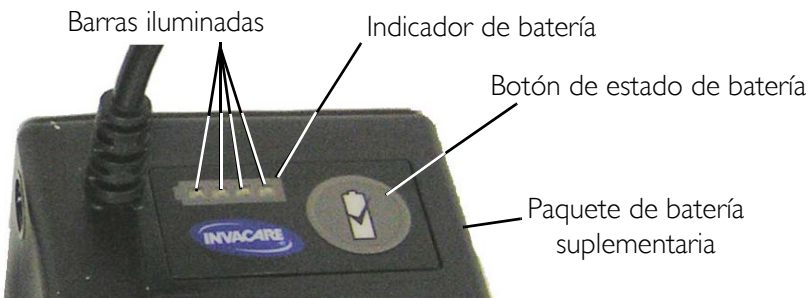
FIGURA 6.6 Prolongación de la vida útil de la batería del equipo XPO 2
