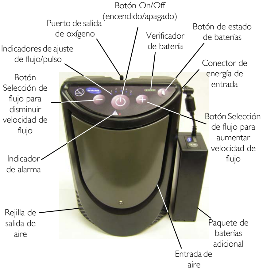
FIGURA 4.1 Características del concentrador XPO2
